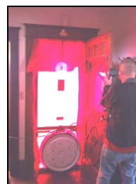
Blower Door Test
